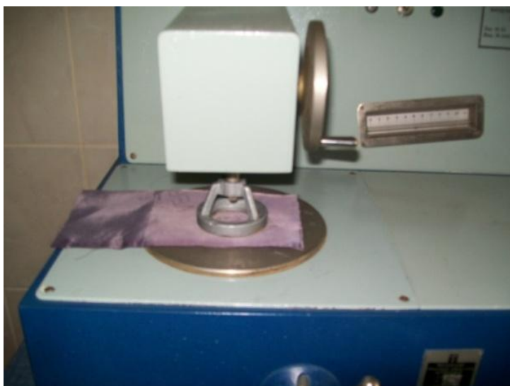
Рис. 6. Фотографічне зображення вимірювання показника повітропроникності тканини підкладкової
